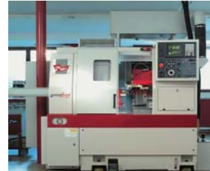
Bild 1: Um die bei der Hochgeschwindigkeitsbearbeitung anfallenden Späne optimal abführen zu können, wurde bei der GrindTurn Alpha eine 60° Schrägbettkonstruktion gewählt
