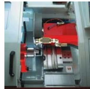
Bild 2: Bei der Grindturn Alpha wird radial eingestochen, um das Fertigteil zu erhalten
